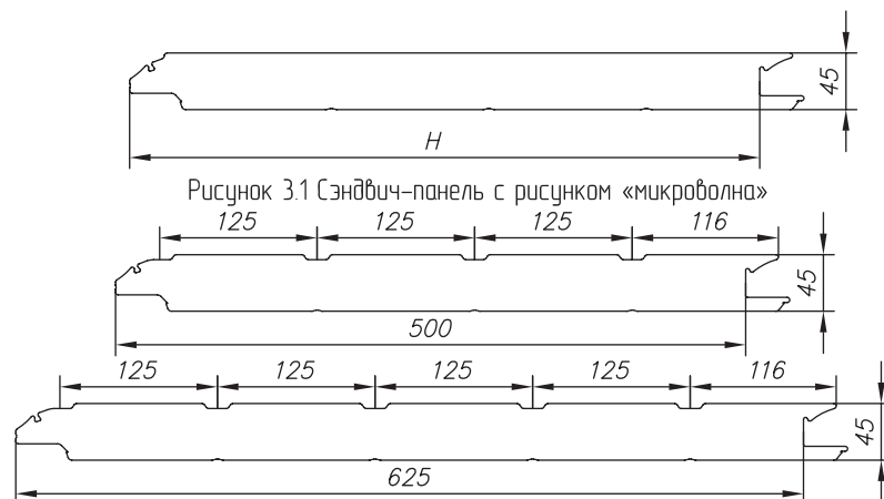
Рисунок 3.2 Сэндвич-панель с горизонтальным гофром
