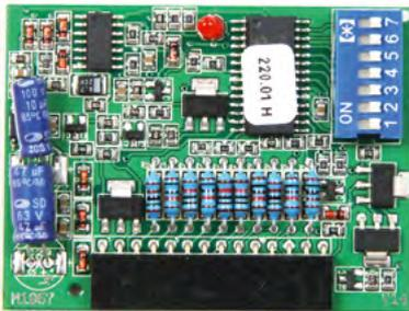
Съемная плата **ZM-SKS B** расширяет функциональные возможности приводов серии **STA**.
