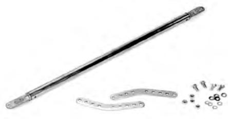
Удлинительная тяга используется для высокого монтажа ворот. Осуществляет перемещение точек приложения тягового усилия при отсутствии возможности монтажа направляющей на перемычке или над полотном ворот. Поставляется в длинном (2,125 м) и коротком (1 м) исполнении) для различных высот расположения горизонтальной направляющей от верха проема (HL).
