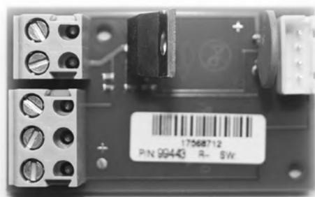
Модуль необходим для подключения сигнальной лампы Control 950 к приводу Comfort 270/280.
