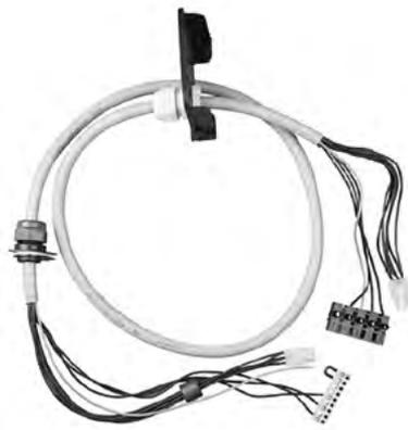
Соединительный кабель для подключения блока управления **CS300** к приводам **STA/MDF**. Оснащен встроенным нагревательным элементом, что позволяет эксплуатировать систему в неотапливаемых помещениях с температурой до  $-25^{\circ}\text{C}$ .
